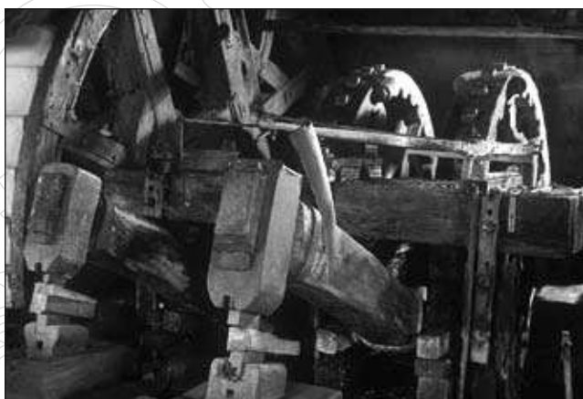
Roue hydraulique à augets, taillanderie de Nans-sous-Sainte-Anne.
